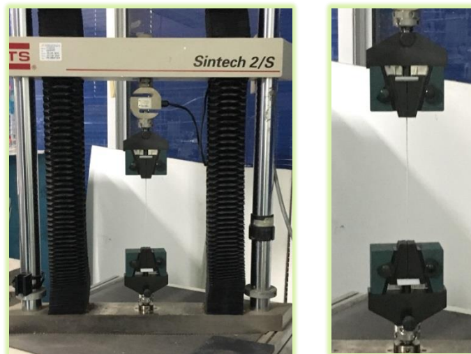
ภาพที่ 3 การทดสอบความต้านทานแรงดึงกระดาษด้วยเครื่องชุดทดสอบวัสดุ (Universal Testing Machine)
